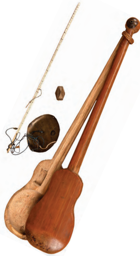
Kinesisk vekt med trefutteral, 1780-1833, lengde 25 cm. Skal ha vært brukt til å veie gull. AAM.08263. |
