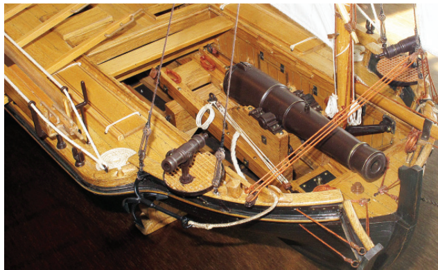
Modell av kanonsjalupp – baugpartiet som viser 24 punds kanon i stevnen og 4 punds gaffelmonterte, svingbare haubitser (også kalt «svingbasser») på hver side av relingen.
