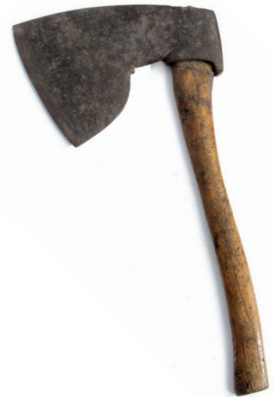
Tømmermannsøks med skaft av bjerk. Har tilhørt skipstømmermann Anders Tjøstolvsen Øren (1858-1935) som arbeidet på Holmen Verft i Risør. KUBEN, AAM.20237. Foto: Karl Ragnar Gjertsen.
