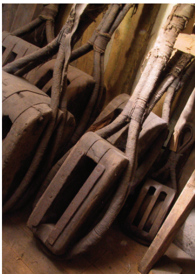
Taljer eller blokker brukt til kjølhaling. Blokken i midten stammer fra Kolbjørnsvik Kran. KUBEN, AAM.07256. Foto: Karl Ragnar Gjertsen.
